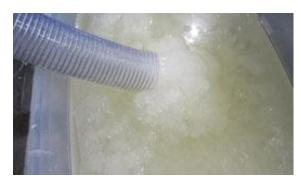
流态冰,一种流体形态的冰,无数微小冰晶和水溶 液(常为盐水、海水或乙二醇)的混合物。因其特 殊的半液体形态,流态冰也被称作液体冰,流冰, 流体冰等。
